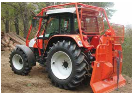
Forsttraktor mit angebaute Seilwinde
