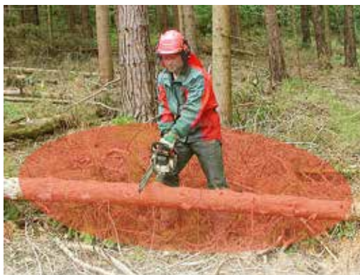
Schwenkbereich der Motorsäge – 2 Meter Sicherheitsabstand
