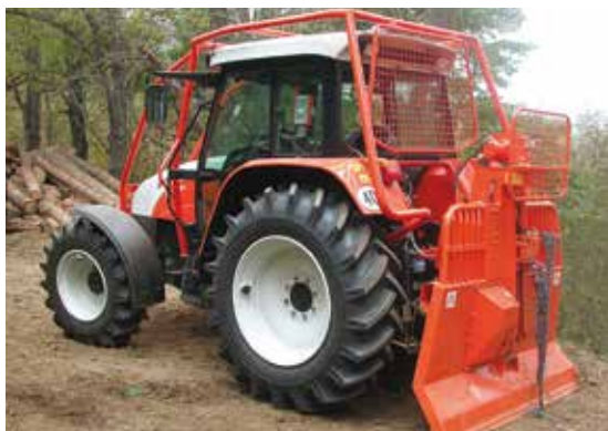
Forsttraktor mit angebaute Seilwinde
