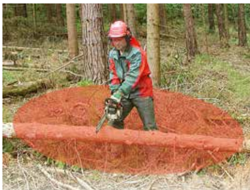
Schwenkbereich der Motorsäge – 2 Meter Sicherheitsabstand
