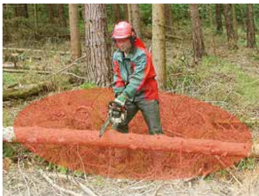
Schwenkbereich der Motorsäge – 2 Meter Sicherheitsabstand
