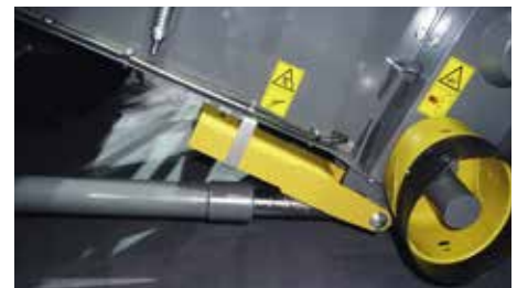
Mechanische Sicherung des Schneidwerks:
