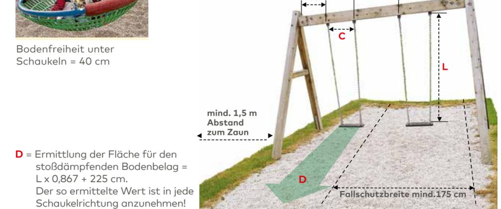
**D** = Ermittlung der Fläche für den stoßdämpfenden Bodenbelag =  $L \times 0,867 + 225$  cm. Der so ermittelte Wert ist in jede Schaukelrichtung anzunehmen!
