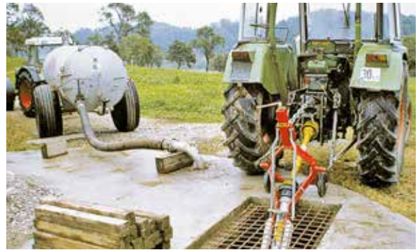
(oben) Grube mit fixem Ansaugrohr und Schutzgitter für Güllemixer
