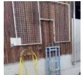
(oben) Grube mit fixem Ansaugrohr und Schutzgitter für Güllemixer
