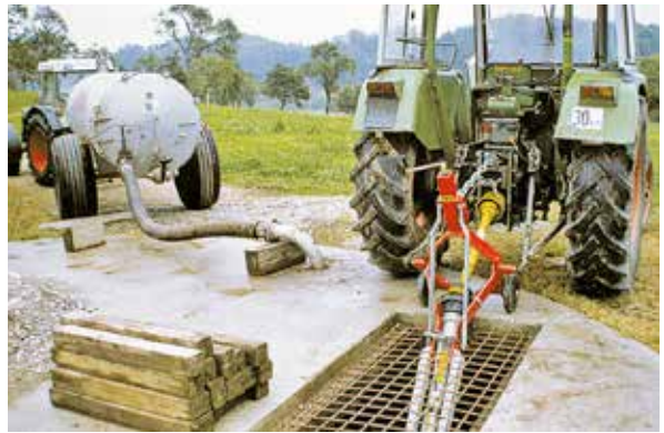
Grube mit fixem Ansaugrohr und Schutzgitter für Güllemixer
