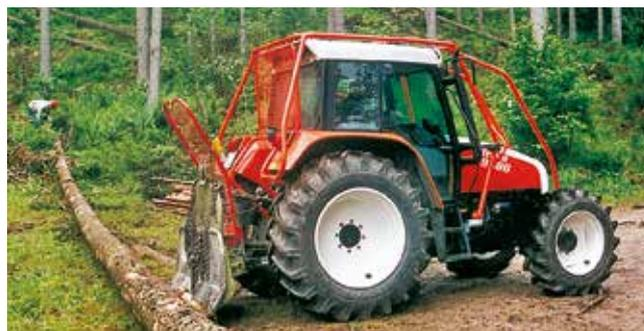
Neben der meist verwendeten Anbauseilwinde werden fallweise auch Aufbauwinden, Rückewagen sowie -zangen eingesetzt.
