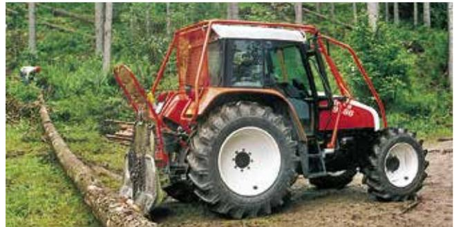
Neben der meist verwendeten Anbauseilwinde werden fallweise auch Aufbauwinden, Rückewagen sowie -zangen eingesetzt.
