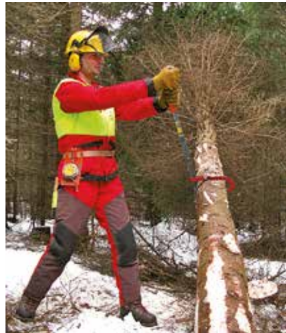
Abdrehen bzw. Abschaukeln mit dem Wendehaken des Fällhebels
