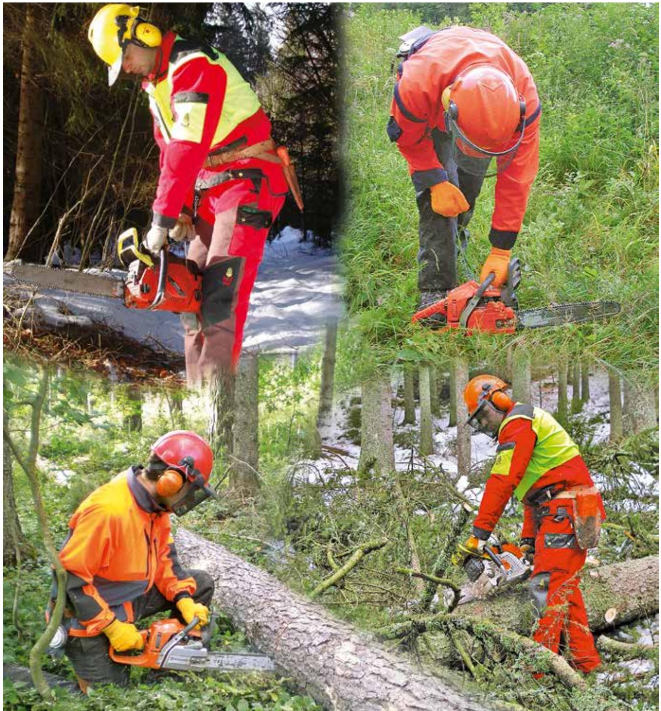
Die Hände umfassen die Haltegriffe so, dass der Daumen stets den Griff umschließt (geschlossener Griff). Die Motorsäge ist immer mit beiden Händen zu halten!
