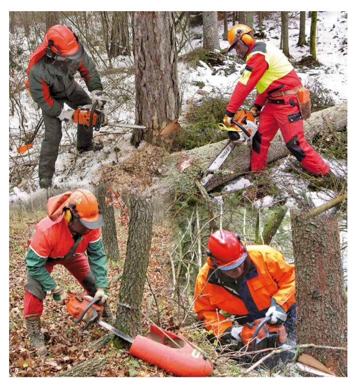
Die Anwendung des Schrägschnittes im Schwachholz bringt eine Entlastung des Rückens. Um die Bückarbeit zu minimieren, ist es besser, sich z.B. beim Fällschnitt niederzuknien.
