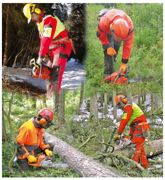
Die Hände umfassen die Haltegriffe so, dass der Daumen stets den Griff umschließt (geschlossener Griff). Die Motorsäge ist immer mit beiden Händen zu halten! Die Motorsäge soll beim Schneiden möglichst abgestützt werden (am Stamm oder am rechten Oberschenkel). Das Abstützen erhöht die Sicherheit und erleichtert die Haltearbeit.
