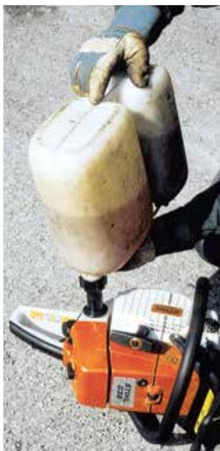
Vor dem **Betanken** ist der Motorsägenmotor abzustellen. Beim Einfüllen von Kraftstoff darf nicht geraucht werden; von offenem Feuer ist genügend Abstand zu halten. Spezial-Einfüllstutzen verhindern das Verschütten von Treibstoff. Wegen der Giftigkeit der Abgase dürfen Motorsägen mit Verbrennungsmotoren nicht in geschlossenen Räumen betrieben werden.
