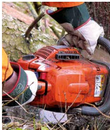
Beim Schneiden ist die Motorsäge mit beiden Händen im **geschlossenen Griff** festzuhalten und möglichst abzustützen.
