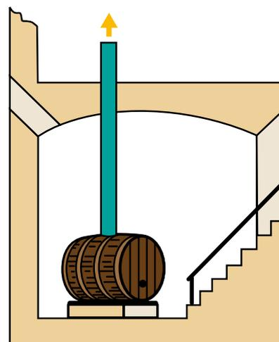
Bei beiden Sicherheitseinrichtungen ist die Auslassöffnung so zu wählen, dass das Kohlenstoffdioxid nicht wieder in den Keller zurückfließen kann und es zu keiner Gefährdung von betriebsfremden Personen kommt. Kohlenstoffdioxid kann durch Mauern und Erdspalten auch in benachbarte und darunterliegende Keller fließen. Daher sind die Besitzer dieser Keller vor dem Einsetzen der Gärung zu warnen.
