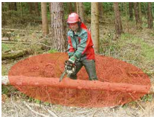
Schwenkbereich der Motorsäge – 2 Meter Sicherheitsabstand
