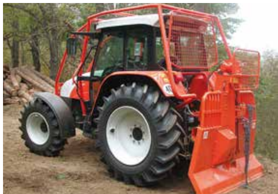
Forsttraktor mit angebaute Seilwinde
