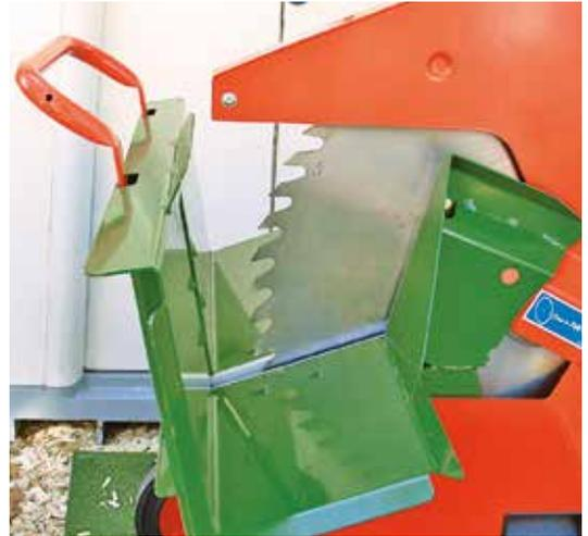
Durch die geschlossene Bauweise sind halbautomatische oder automatische Sägemaschinen sicher zu bedienen. Zusätzlich wird die Arbeitsleistung und der Bedienkomfort erhöht!
