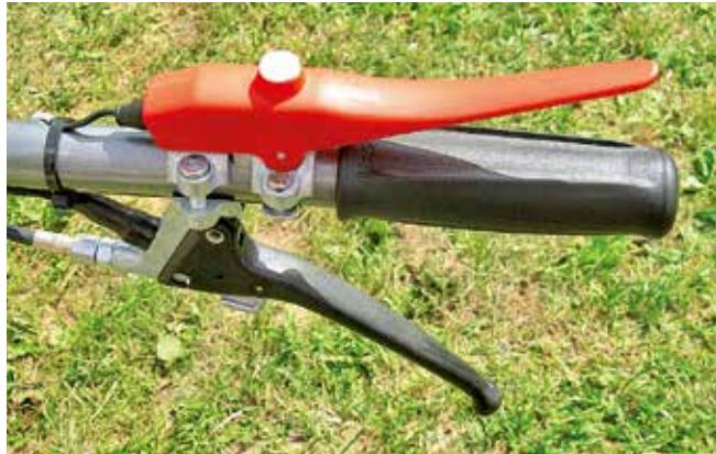
Bei handgeführten Maschinen (z.B. Motormäher) wird durch Loslassen der „Totmannschaltung“ der Antrieb bzw. Motor sofort stillgesetzt.
