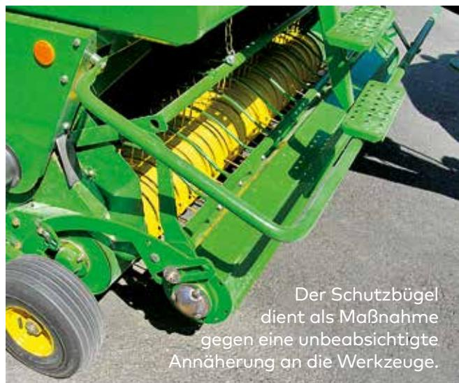
Der Schutzbügel dient als Maßnahme gegen eine unbeabsichtigte Annäherung an die Werkzeuge.
