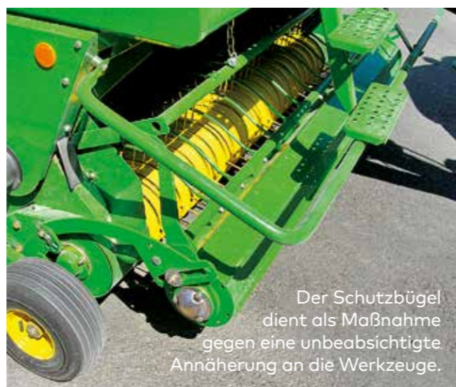
Bewegliche Teile der Kraftübertragung müssen mit Schutzeinrichtungen versehen sein.
