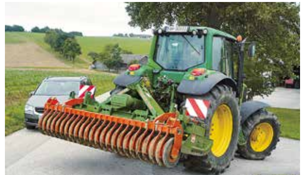
Anbaugeräte scheren bei Kurvenfahrt aus.
