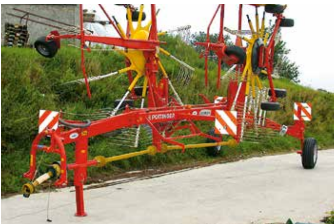
Einphasenkuppler (Anbaudreieck): Damit ist ein automatisches An- und Abkuppeln der Gelenkwelle und Hydraulikanschlüsse möglich.
