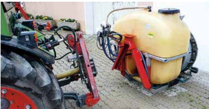
Einphasenkuppler (Anbaudreieck): Damit ist ein automatisches An- und Abkuppeln der Gelenkwelle und Hydraulikanschlüsse möglich.
