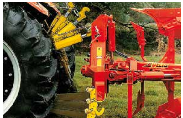
Zweiphasenkuppler: Fanghaken auf Unter- und Oberlenker
