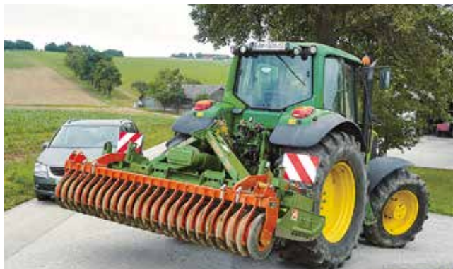
Anbaugeräte scheren bei Kurvenfahrt aus.
