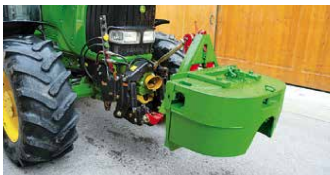
Ballastgewichte anbringen; zulässige Achsbelastung beachten.
