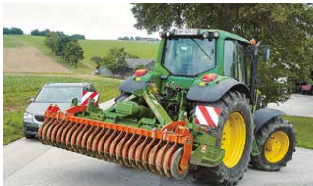
Anbaugeräte scheren bei Kurvenfahrt aus.
