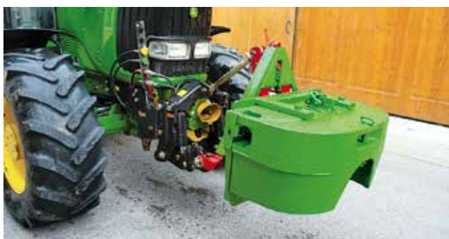
Ballastgewichte anbringen; zulässige Achsbelastung beachten.
