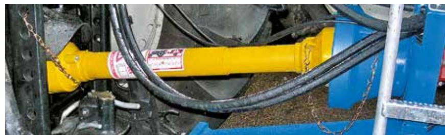
Bei gestreckter Gelenkrolle muss das Schutzschild bzw. der Schutzenkopf die Schutztrichter der Gelenkrolle überdecken. Eine ausreichende Überdeckung muss auch bei Weitwinkelgelenkwellen, Überlastkupplungen sowie abgewinkelten Gelenkwellen gewährleistet sein.
