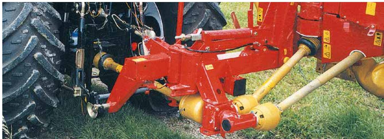
Vor dem Ersteinsatz einer Maschine ist die richtige Länge der Welle und der Schutzrohre zu überprüfen. Schutztrichter und Schutzrohre dürfen in allen Betriebszuständen bei unterschiedlichen Abwinkelungen nicht anstoßen.
