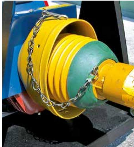
Die Halteketten sind einzuhängen, um das Mitdrehen des Gelenkwellenschutzes zu verhindern. Auf ausreichende Bewegungsfreiheit der Gelenkwelle ist zu achten. Zu kurze Halteketten führen zu Spannungen und reißen aus der Halterung.
