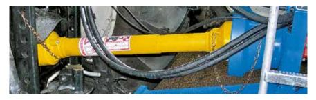
Bei gestreckter Gelenkwelle muss das Schutzschild bzw. der Schutztopf die Schutztrichter der Gelenkwelle überdecken. Eine ausreichende Überdeckung muss auch bei Weitwinkelgelenkwellen, Überlastkupplungen sowie abgewinkelter Gelenkwelle gewährleistet sein.
