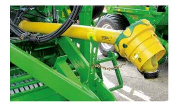
Jede Berührung der Gelenkwelle mit Traktor- oder Maschinenteilen ist zu vermeiden, da die Schutzeinrichtungen beschädigt werden können.
