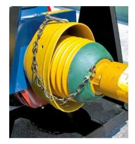
Die Halteketten sind einzuhängen, um das Mitdrehen des Gelenkwellenschutzes zu verhindern. Auf ausreichende Bewegungsfreiheit der Gelenkwelle ist zu achten. Zu kurze Halteketten führen zu Spannungen und reißen aus der Halterung.
