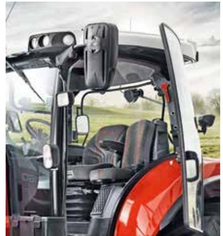
Bei richtiger Gewichtseinstellung haben mechanisch gefederte Sitze gleich gute Dämpfungseigenschaften wie luftgefederte Sitze. Der Sitz darf zu anderen Fahrzeugteilen keine Quetsch- und Scherstellen aufweisen, die zu Verletzungen führen können. Lenkersitze werden mit Horizontalfederung, einstellbarer Rückenlehne, mit Armstützen und auch Sicherheitsgurt angeboten. Ist der Sitz mit einem Gurt ausgerüstet, muss dieser auch verwendet werden.
