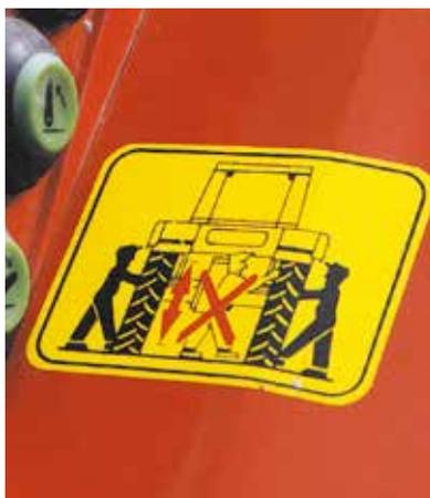
Heckseitig angeordnete Bedienelemente des Hubwerks dürfen nur **seitlich, d.h. außerhalb des Gefahrenbereiches** zwischen Traktor und Gerät betätigt werden.
