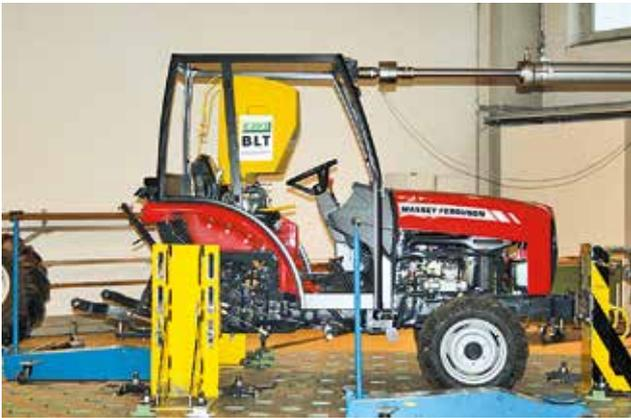
Die wichtigste Aufgabe dieser Sicherheitseinrichtung ist der Schutz des Fahrers bei einem Traktorsturz. In den meisten Fällen wird durch den Fahrerschutz beim seitlichen Sturz ein Weiterrollen bzw. beim Kippen nach hinten ein Überschlag verhindert. Dadurch vermindern sich die Verletzungsgefahr und meistens auch der materielle Schaden.
