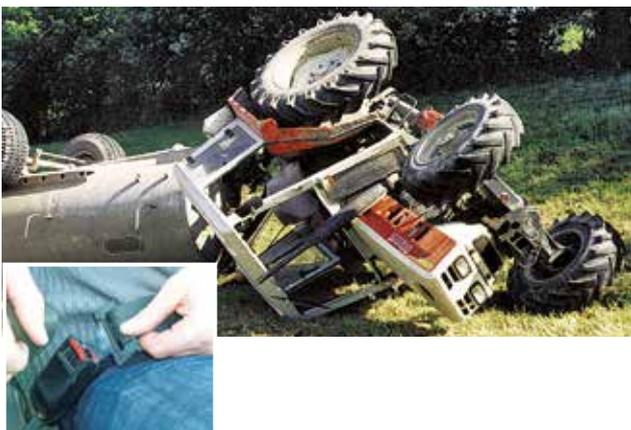
Zugmaschinen dürfen auch mit einem Sicherheitsbügel ausgerüstet sein, welcher den festgesetzten Schutzbereich für den Lenker gewährleisten muss. Bei einem Traktor mit Frontlader ist der Sicherheitsbügel nicht ausreichend, da er keinen Schutz gegen herabfallende Gegenstände (z.B. Rundballen) bietet.
