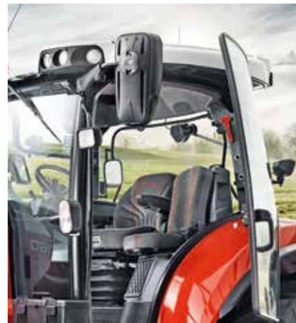
Bei richtiger Gewichtseinstellung haben mechanisch gefederte Sitze gleich gute Dämpfungseigenschaften wie luftgefederte Sitze. Der Sitz darf zu anderen Fahrzeugteilen keine Quetsch- und Scherstellen aufweisen, die zu Verletzungen führen können. Lenkersitze werden mit Horizontalfederung, einstellbarer Rückenlehne, mit Armstützen und auch Sicherheitsgurt angeboten. Ist der Sitz mit einem Gurt ausgerüstet, muss dieser auch verwendet werden.
