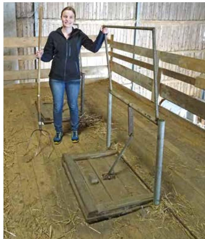
Ein besonders komfortables Öffnen und Schließen des Lukendeckels ermöglicht ein **Schwenkrahmen mit Hebelgelenk**. Für befahrbare Decken kann dieser Schwenkrahmen auch abnehmbar ausgeführt werden.
